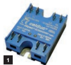
Rele' statici bifasi tipo SOB, pilotano delle resistenze cablate a triangolo. Adatto a carichi in alta tensione, equilibrati o non.
